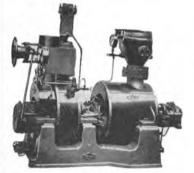
WEIR TURBINE-DRIVEN FEED PUMPS TMFP7
