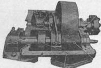
G.E. AUX. TURBO-GEN. REDUCTION GEARS
