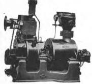
WEIR TURBINE-DRIVEN FEED PUMPS TMFP7
